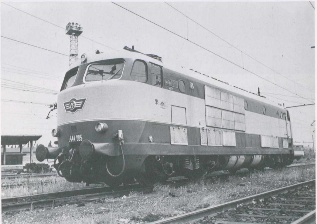
Fig.79 - Locomotiva E.444.005 con regolazione elettronica
