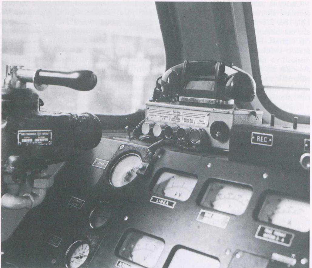
Fig.44 - Telefono terra - treno e dispositivo di allarme nella cabina di una locomotiva
