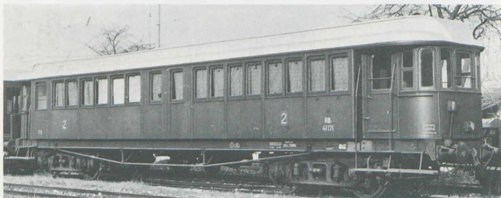
Fig.13 - Carrozza FS ricavata nel 1927 dalla trasformazione di un'elettromotrice RA 324 delle Valtellinesi
