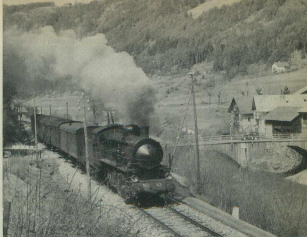
ig. 36 - 1911 - Locomotiva Gr. 740 F.S. a vapore surriscaldato e semplice espansione, potenza 980 CV, velocità massima 65 km/h.
