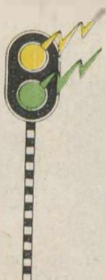
Il successivo segnale di 1<sup>a</sup> categoria è a via libera per un istradamento da impegnarsi a velocità non superiore a 60 Km/ora. Il macchinista perciò deve oltrepassare detto segnale di 1<sup>a</sup> categoria a velocità non superiore a 60 Km/ora e rispettare tale limite anche nel percorrere il successivo gruppo di scambi.
