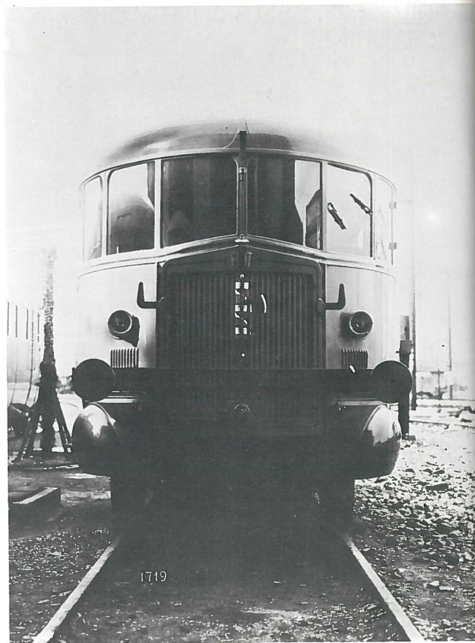
Le prime vere automotrici leggere: qui la ALb 48.103, Fiat 1932, 90 kW (120 CV), 110 km/h, tara 11 t, 48 posti di 3ª classe.
