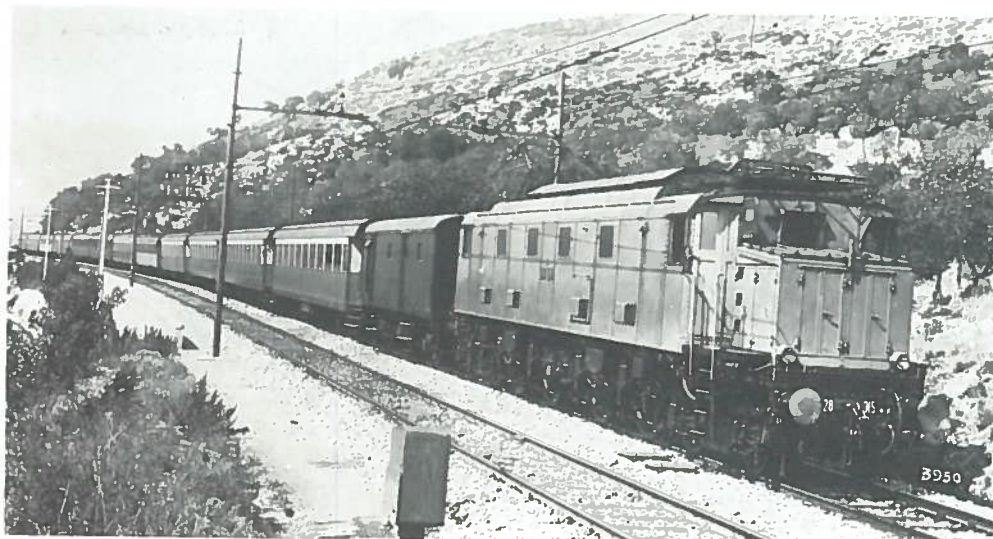
Locomotiva E.428.015 per treni direttissimi pesanti, 8 x 350 kW, 136 t, 130 km/h; 242 unità costruite dal 1934 al 1943.
