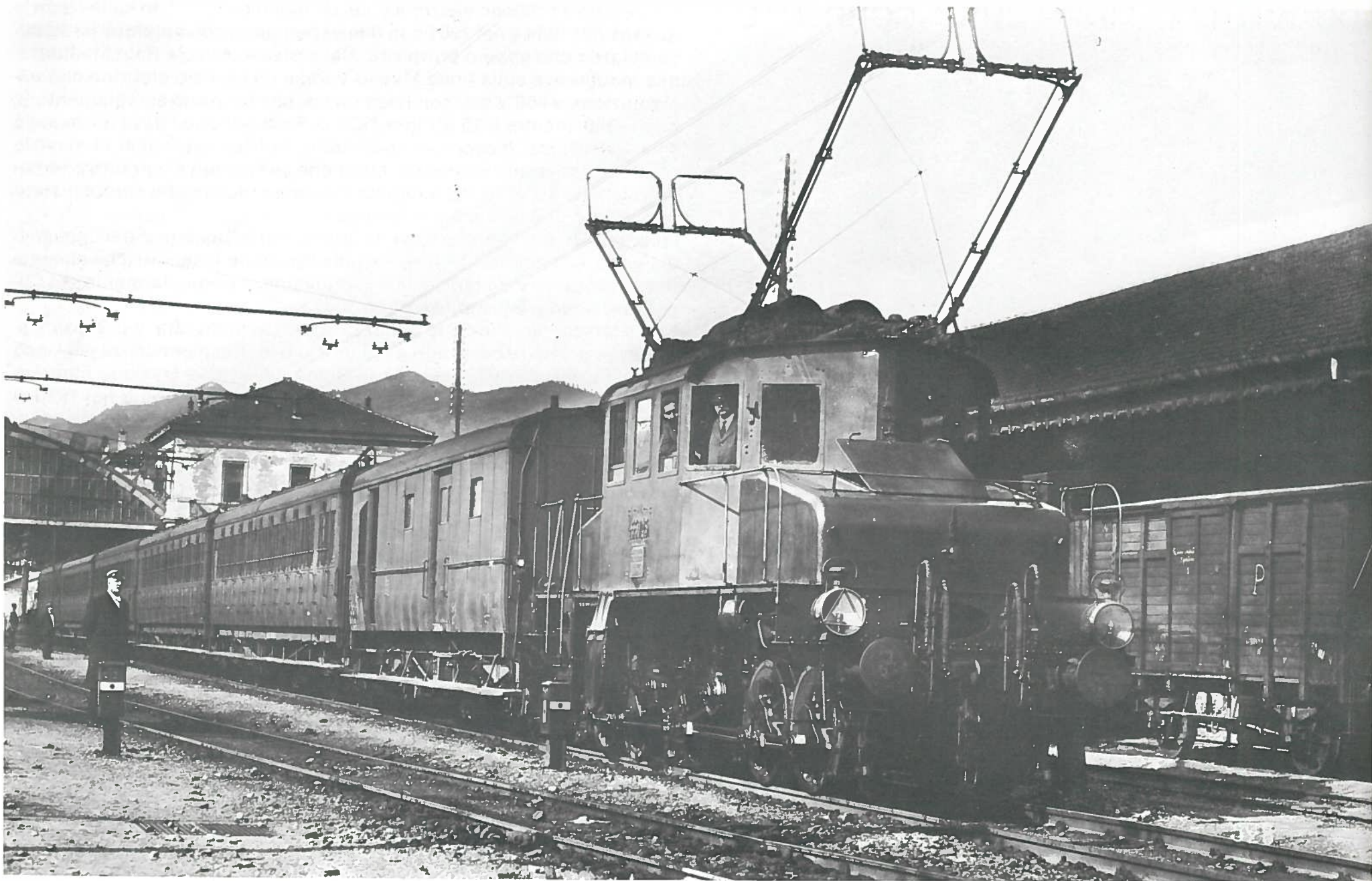
Locomotiva elettrica a corrente trifase, 3600 V 16,7 Hz, E.550.45 ripresa a Savona. 186 unità costruite dal 1908 al 1921, 1500 kW, 25-50 km/h.
