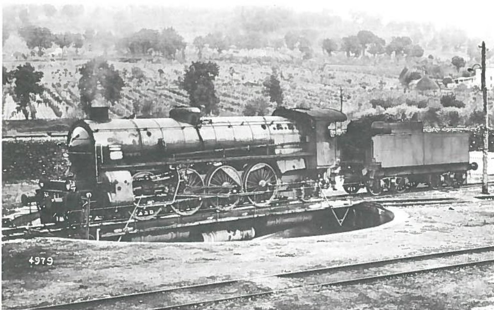
La 746.019, Breda 1923, viene "girata" in due tempi sulla piattaforma del Deposito Locomotive di Chiusi.
