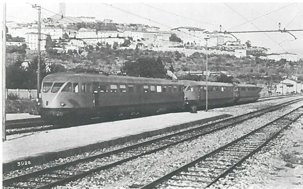
Un convoglio di tre elettromotrici ALe 792-882: 22 unità costruite nel 1937, tara 37 t, 300 kW, 130 km/h.
