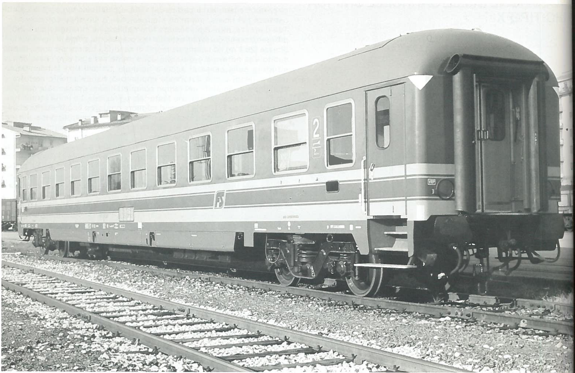
Carrozza UIC-X di seconda classe con cuccette, completamente climatizzata, nei nuovi colori adottati per le carrozze dei treni a lungo percorso.
