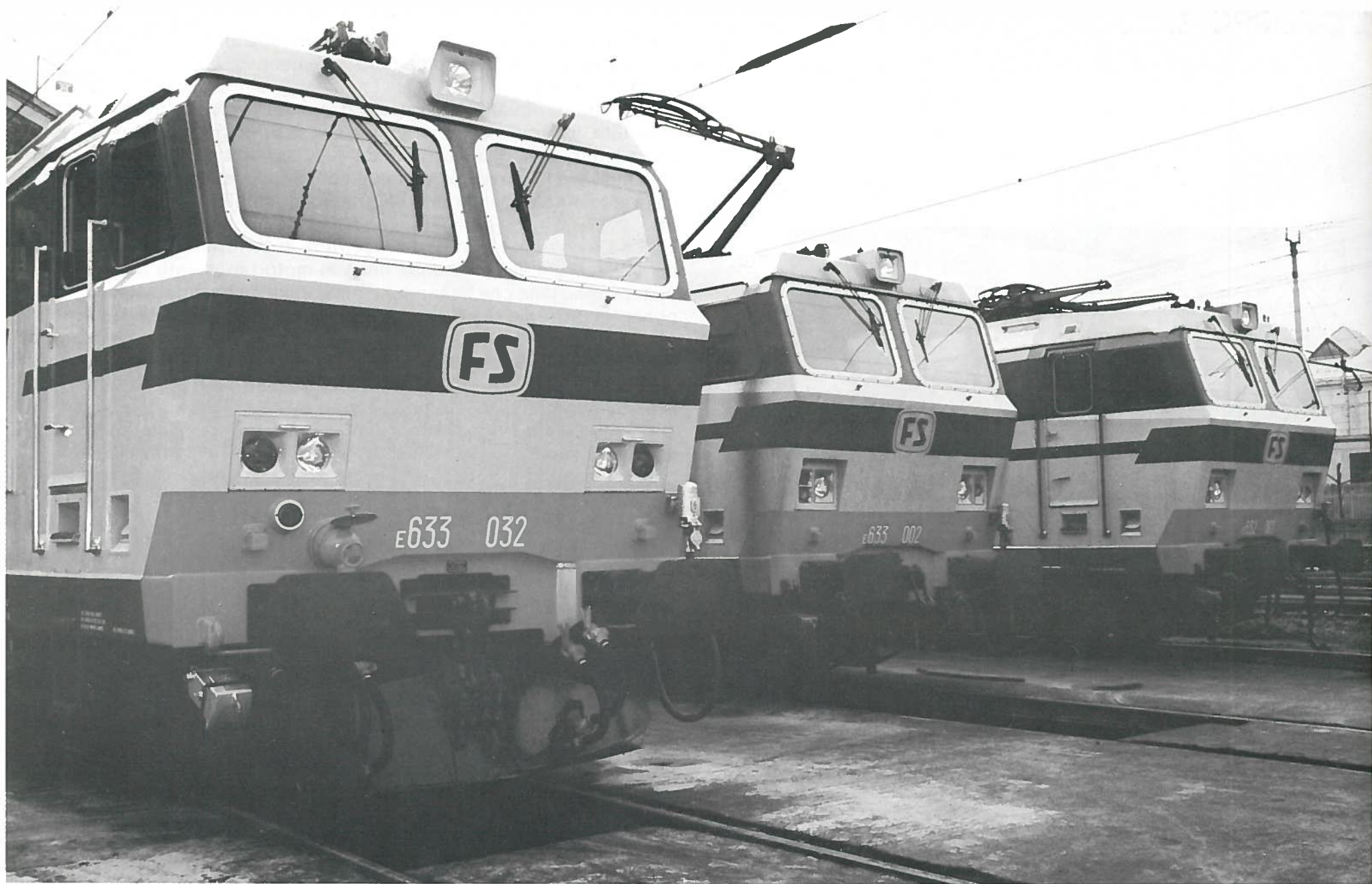
Locomotive elettriche a chopper dei gruppi E.632 ed E.633: mezzi universali per servizi viaggiatori (160 km/h) e merci (130 km/h), 3 x 1570 kW, 103 t.
