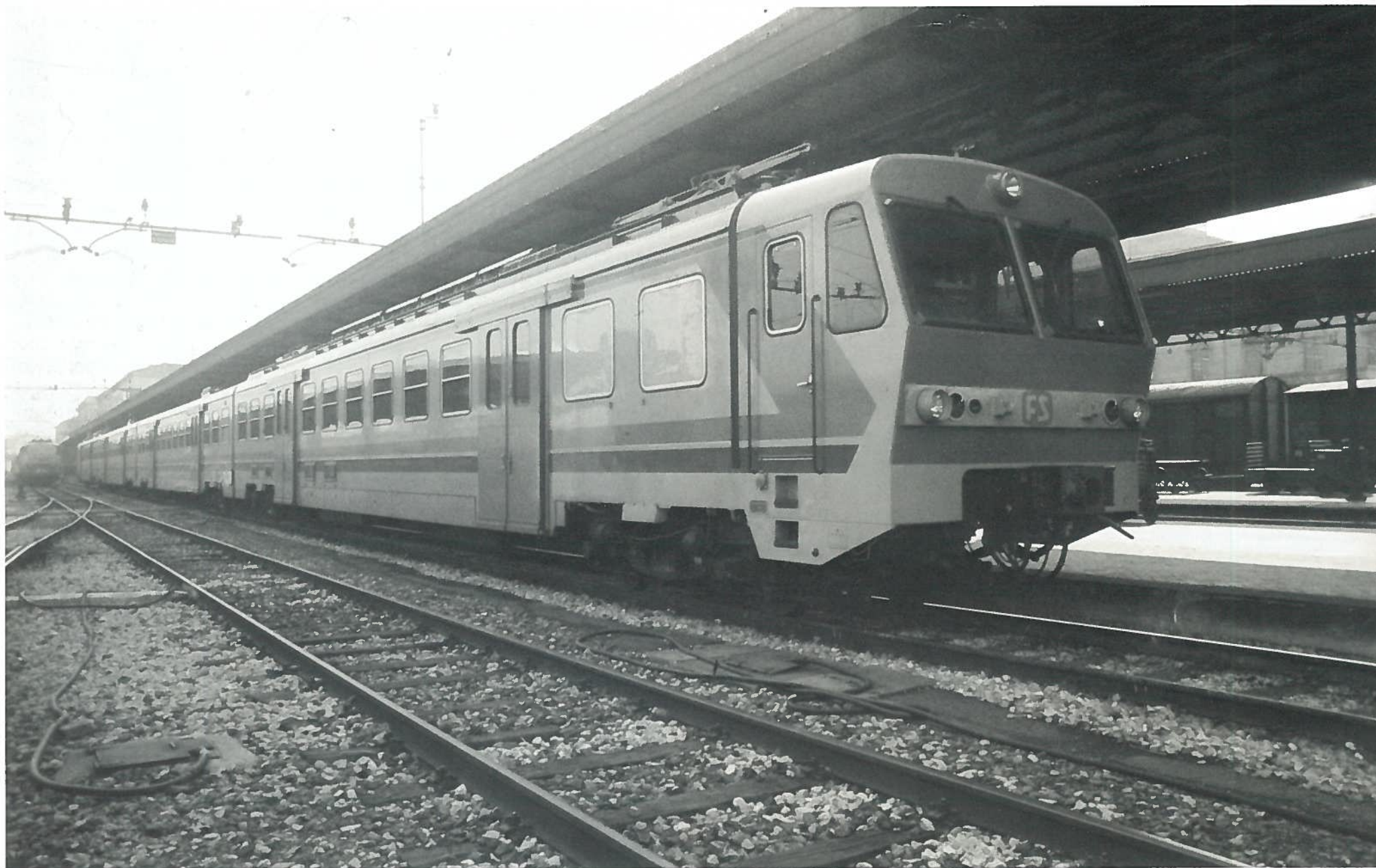
Un moderno complesso di elettromotrici a chopper, ALe 724, e rimorchiate. 140 km/h, 1252 kW per ogni motrice.
