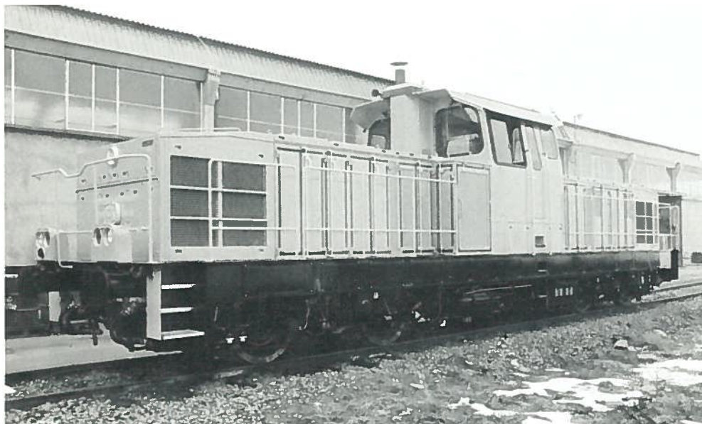
Locomotiva Diesel-elettrica da manovra pesante, ad inverter, D.145.1008, Savigliano 1983. 2 x 410 kW (560 CV), 100 km/h.
