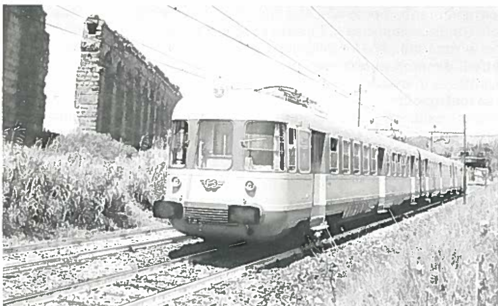
Treno per servizio suburbano, composto dall'elettromotrice ALe 803.005 con un rimorchio ed un rimorchio semipilota. 1048 kW, 240 posti, 130 km/h.
