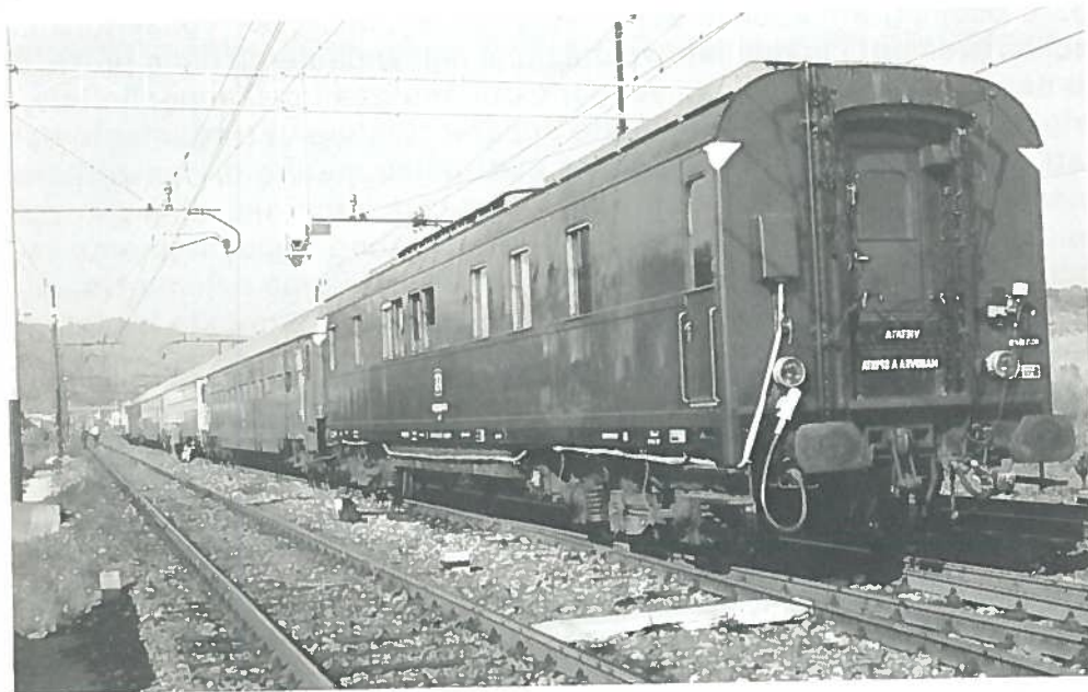
Treno di prova con la carrozza oscillografica 60 83 99-99 001-9, ricavata nel 1956 dalla trasformazione di un salone del 1928 (Foto Roberti).
