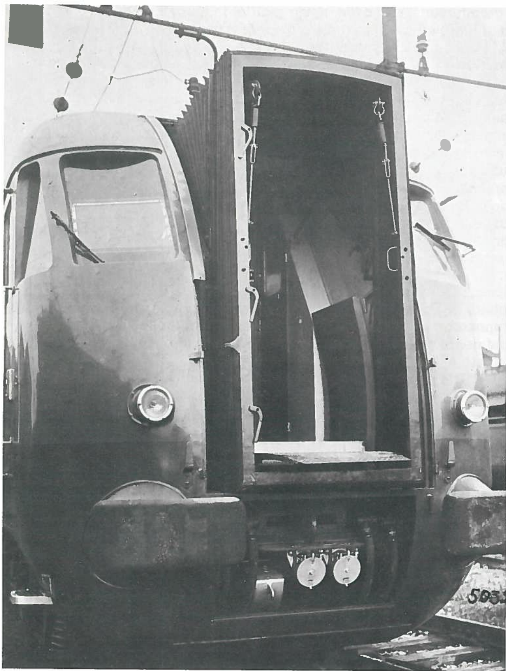
Dettaglio della testata aerodinamica, con mantice di intercomunicazione rientrante, di una ALe 840.
