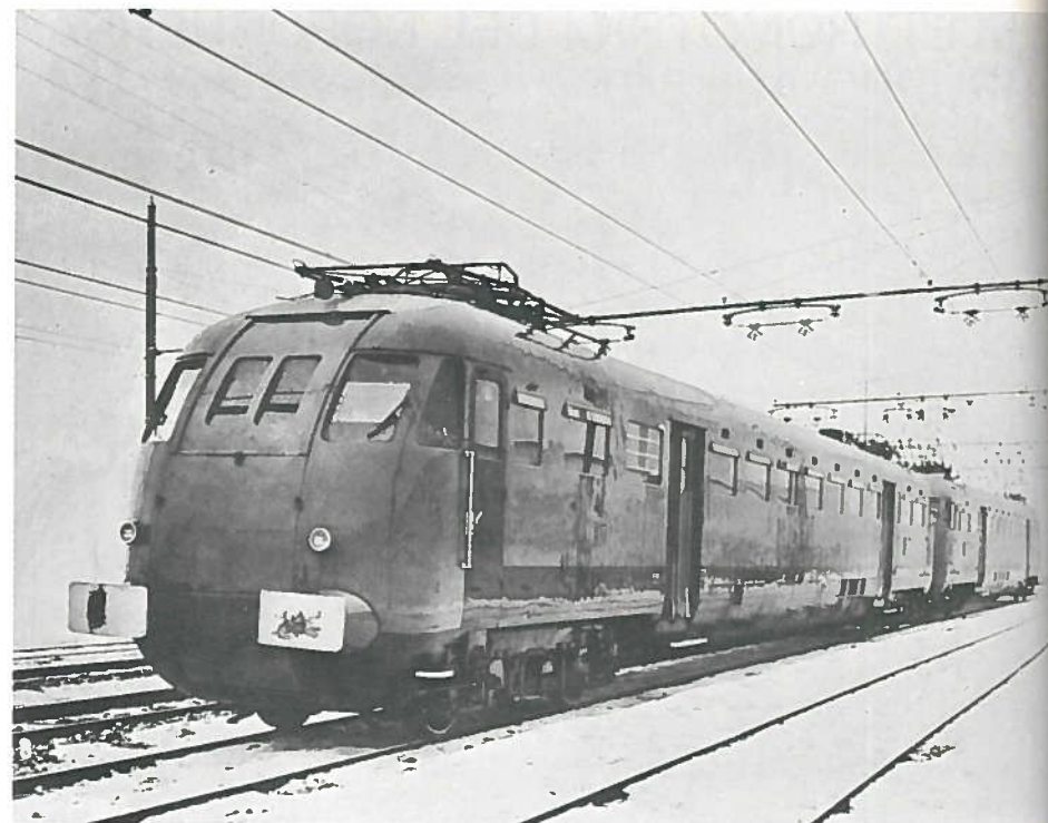
Complesso costituito da una elettromotrice ALe 840 e da un rimorchio con pantografi ed apparecchiature di conversione per alimentazione trifase.
