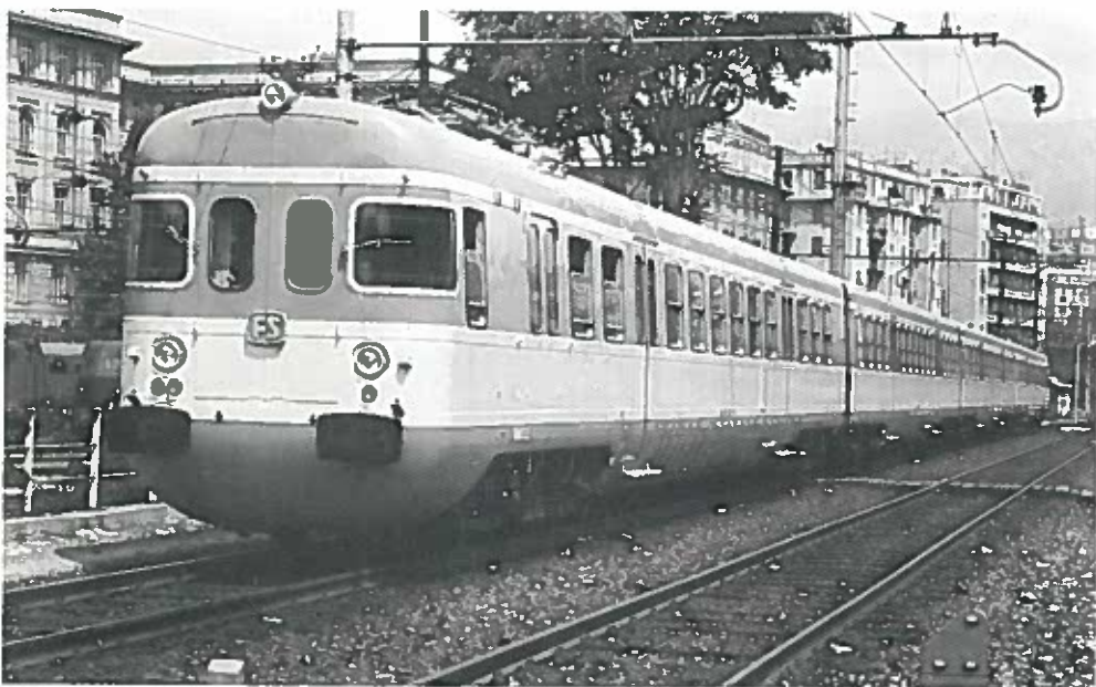
Un più recente treno suburbano, costituito da due elettromotrici ALe 801 o 940 e due rimorchiare intermedie. 2096 kW, 400 posti, 140 km/h.
