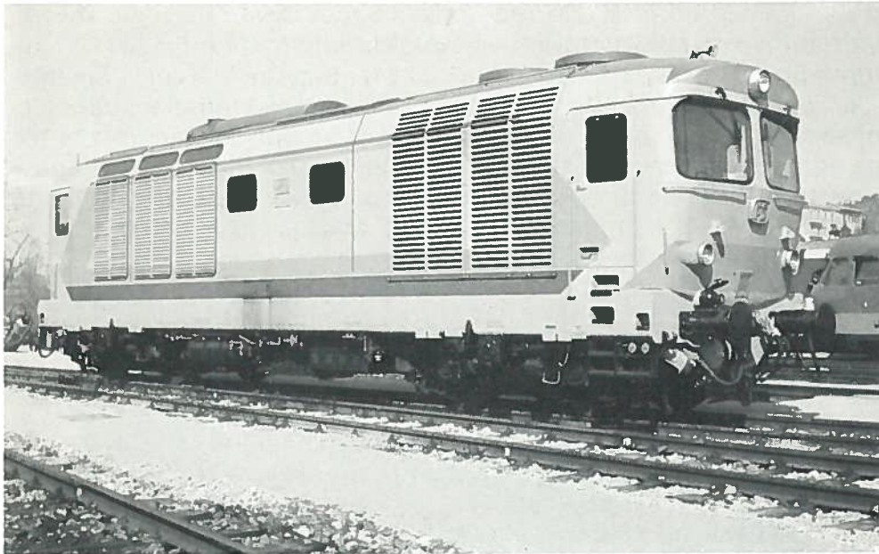
Locomotiva Diesel-elettrica D.445.1037, Savigliano 1982, telecomandabile e con erogazione del riscaldamento elettrico. 1560 kW (2120 CV), 130 km/h.
