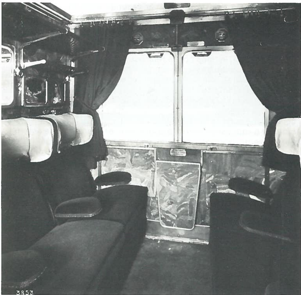
Compartimenti di prima, e di terza classe di una ABCz gruppo 61.000. Si noti la terza classe, per la prima volta imbottita.
