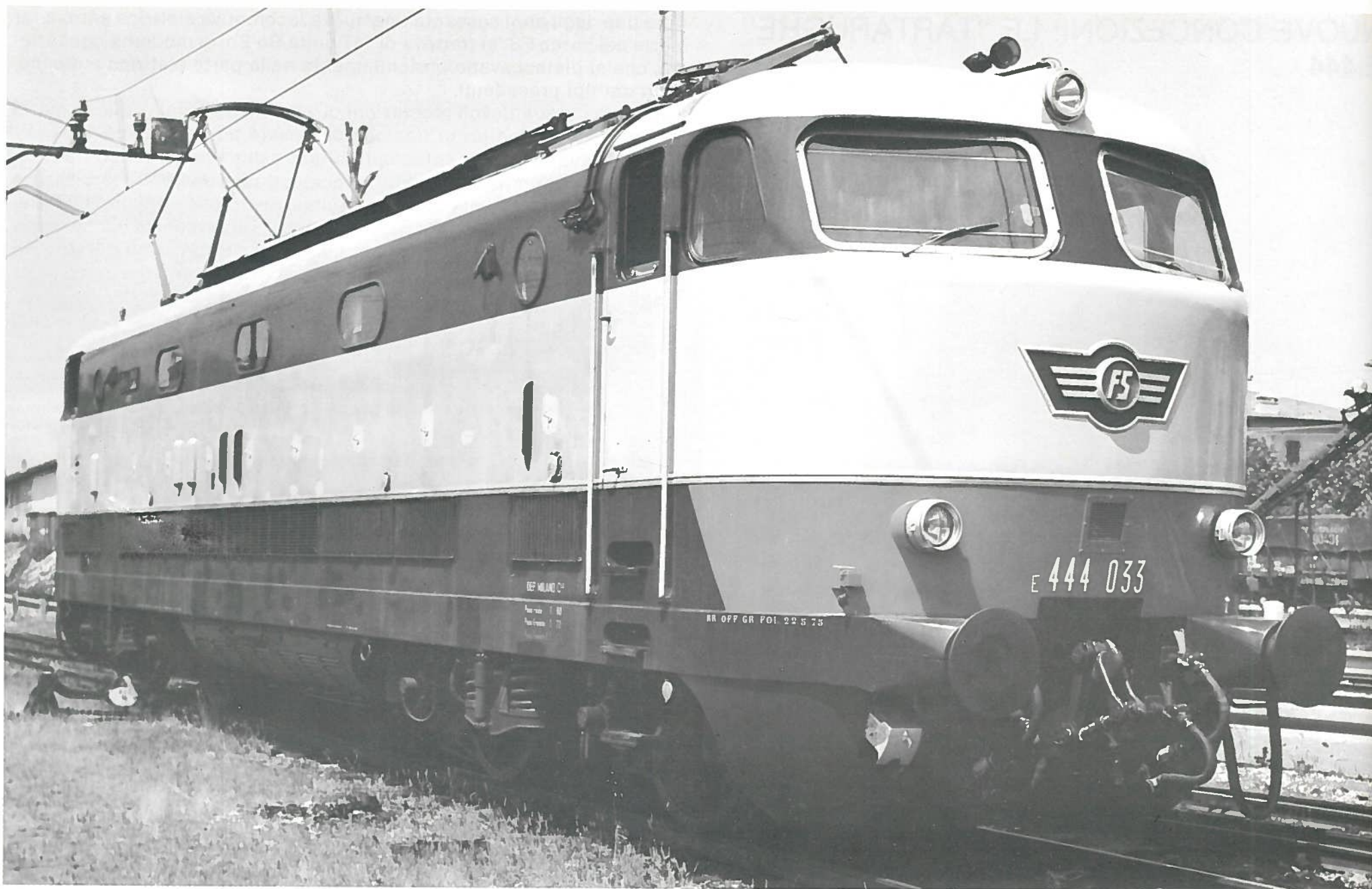
Locomotiva elettrica E.444.033, versione di serie: 4 x 1110 kW, 80 t, 200 km/h; 112 unità costruite dal 1970 al 1974, più un prototipo a chopper.
